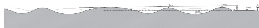
ontwerpprincipe voor het toekomstige noordduin. het duin wordt aan de boulevard niet verhoogd tov de huidige situatie. dittoeft zicht over het duin
